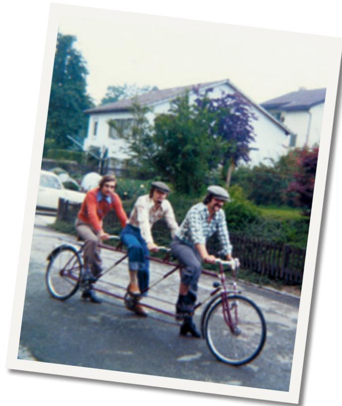
Ein Bubentraum, mit 22 Jahren verwicklicht. Man nehme drei alte Militärvelos, schweisse sie an den richtigen Orten zusammen, verbinde das Konstrukt oben und unten mit Wasserleitungen, die das Gestell stabilisieren, hänge die Kette ein – und fahre!
